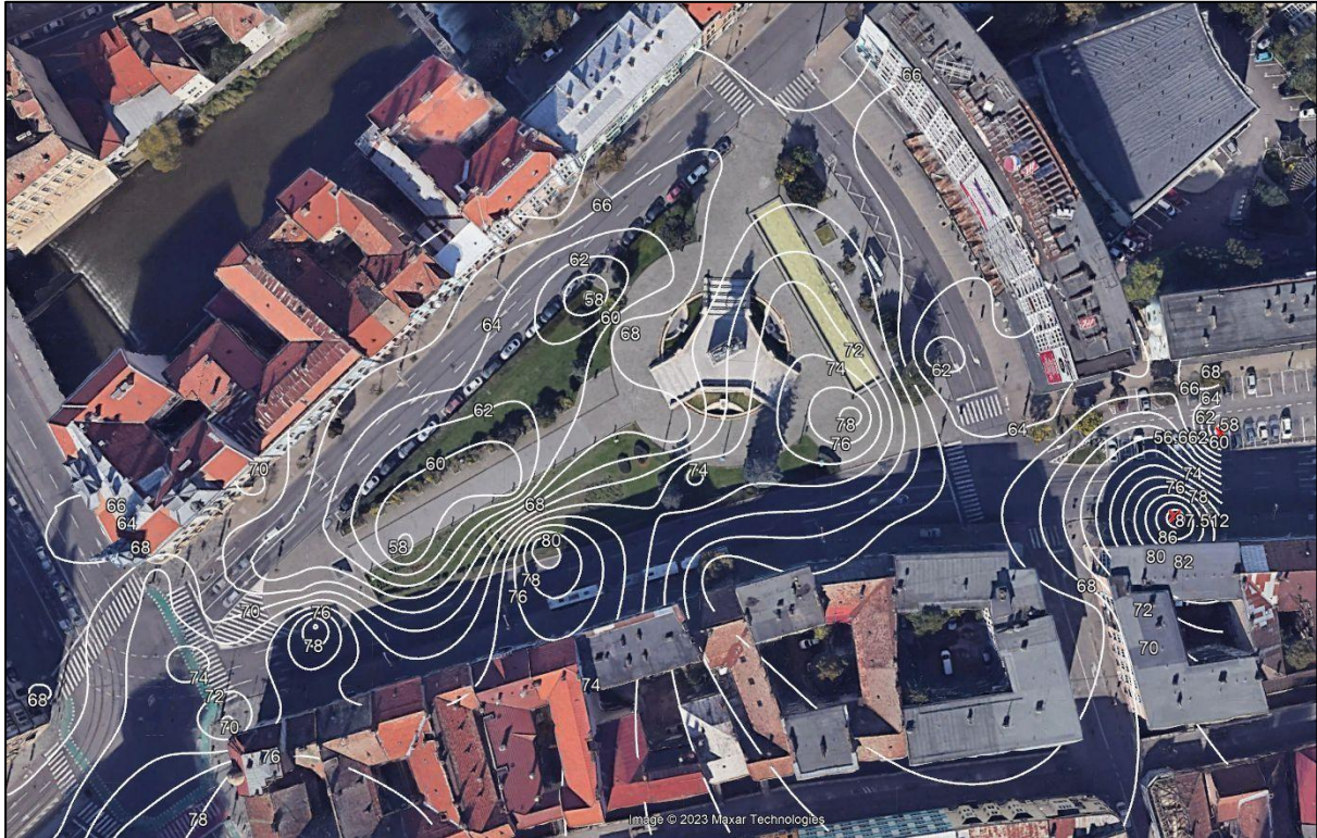
Figura nr. 3. Harta în izofone a pieței Mihai Viteazu realizată pentru valori maxime, la înălțimea de 1,80 m, pe baza măsurătorilor din data de 12.07.2022, din intervalul orar 10.20-12,13 (realizare personală pe suport Google Earth, accesat în dat de 14.08 2023)
