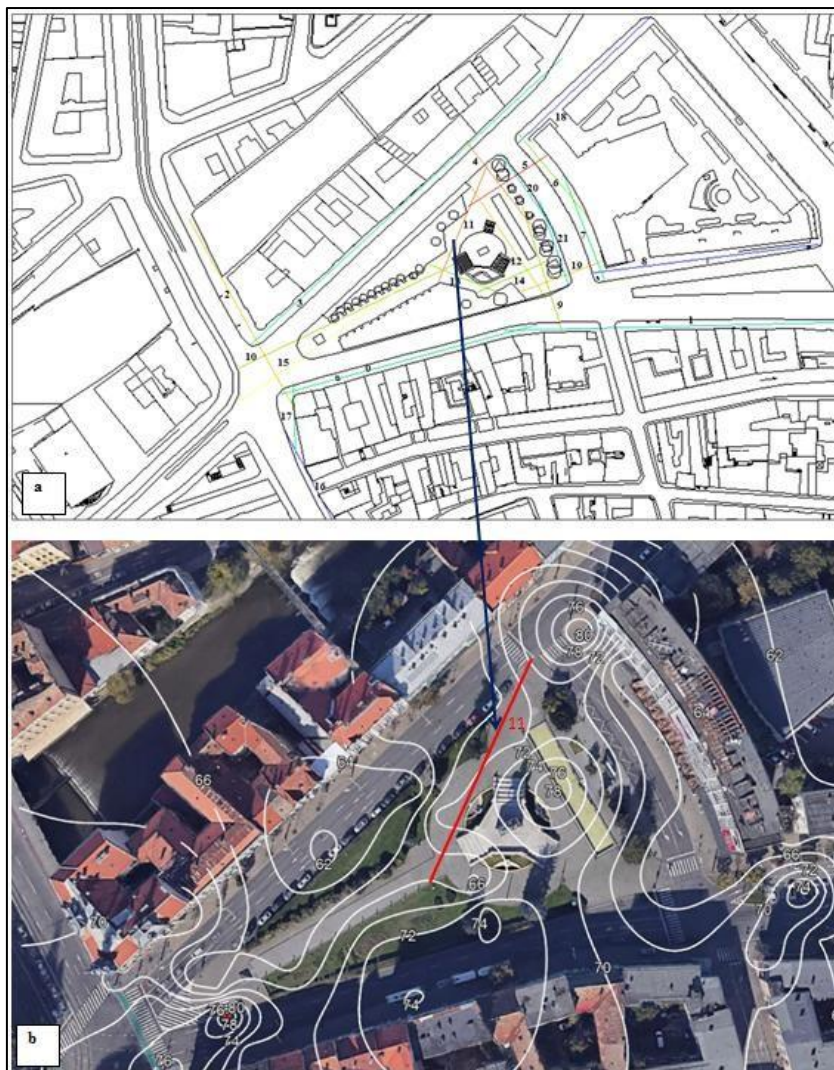
Figura 5. Tehnica de atribuire liniilor axiale valori sonore utilizând hărți în izofone (b) și hărți realizate în DepthMapX de trasare a liniilor axiale pe un suport dxf (a) (a fost utilizată metoda trasării de operator verificată cu metoda trasării automate) (realizare personală)
